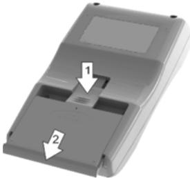
Figura 6 – Compartimento de Baterias
