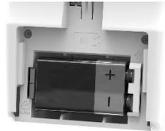
Figura 7 – Compartimento de Baterias
